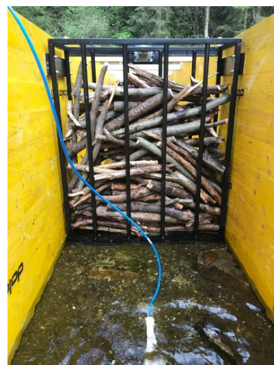
Abbildung 2 Versuchsanlage mit befülltem Verklausungskorb
