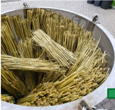
Aufschluss der Hanffasern mittels Hydrolyse
