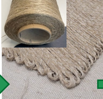
Herstellung eines gestickten Geleges aus Hanffasergarn
