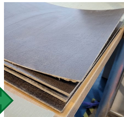
Vylisování do desek za využití umělé pryskyřice
