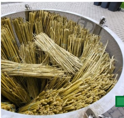
Uvolnění konopných vláken pomocí hydrolýzy
