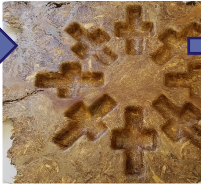
Produkt z banánových vláken jako obalový materiál
