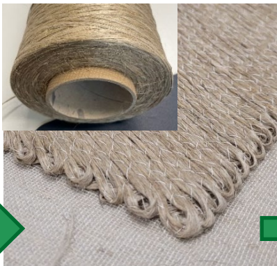
Výroba prošivaných matric z konopné příže
